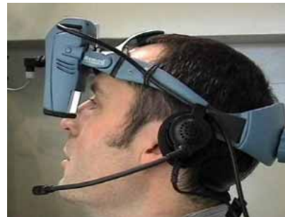
有視界飛行ができないときに、パイロットの頭の位置を検出して、あたかも有視界飛行のような画面を表示
