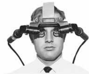
ダモクレスの剣:人の頭の動きに合わせてワイヤフレームの見え方を変更
